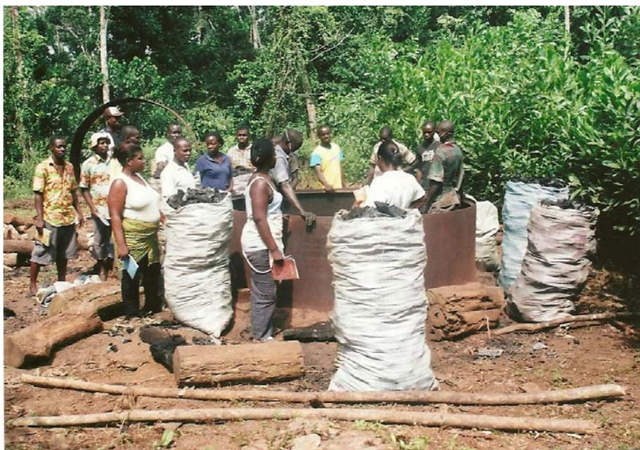
Figure 8 : défournement du four métallique
