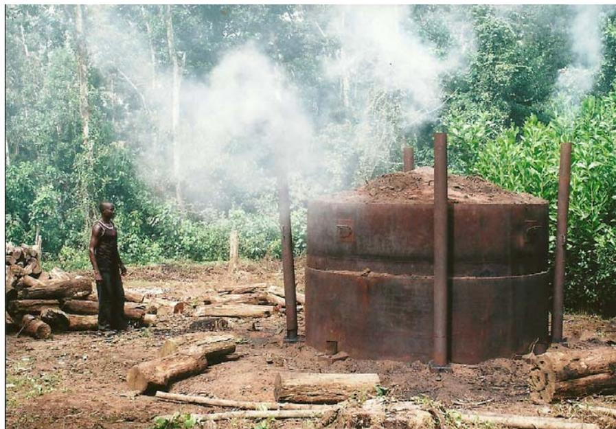
Figure 6 : Four métallique de type « Magnien » de 10 m<sup>3</sup>, projet PRBE-UEMOA à Dabou
